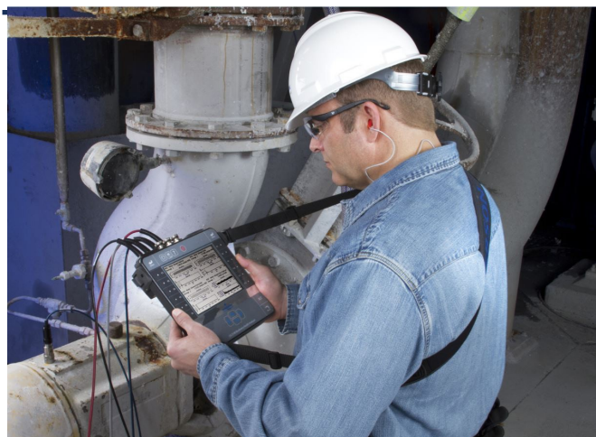
Fig. 1. Análisis de la señal de corriente del motor.
